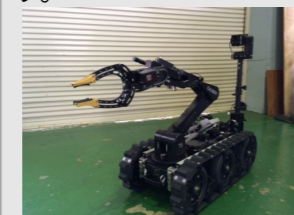
(参考) 除染・がれき回収アームロボット
