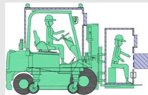
(参考) 移動式作業用遮へいボックス
